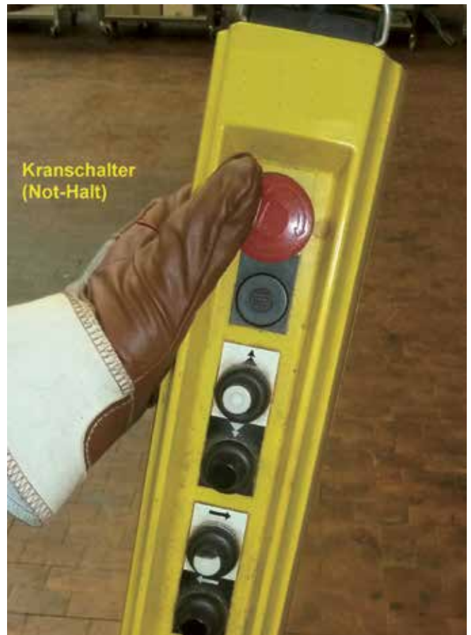
Bild 7-3: Bei flurgesteuerten Kranen wird der Kranschalter durch Drücken des auch als „Not-Halt-Schalter“ bezeichneten roten Pilztasters betätigt
