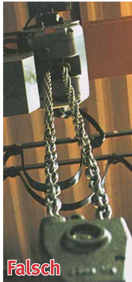
Bild 4-12: Ein Blick in Längsrichtung der hängenden Hubkette genügt, um festzustellen, dass die Kette verdreht ist
