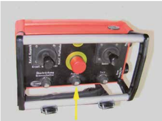
Bild 4-10: Zum Prüfen des Hubnotenschalters muss der Betriebsendschalter – falls vorhanden – überbrückt werden können. Der entsprechende Schalter ist in der Steuertafel untergebracht
