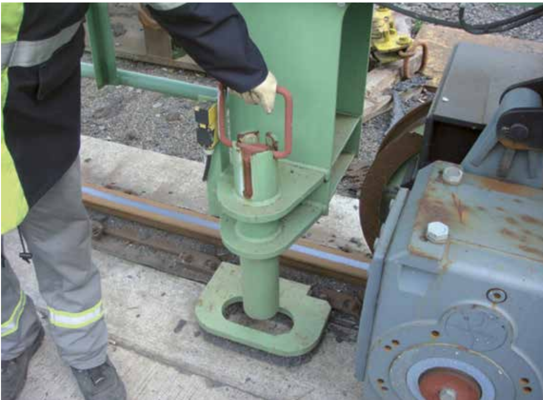
Bild 7-4: Der Portal- kran kann an ver- schiedenen Stellen durch verbolzen gegen abtreiben durch Wind gesichert werden
