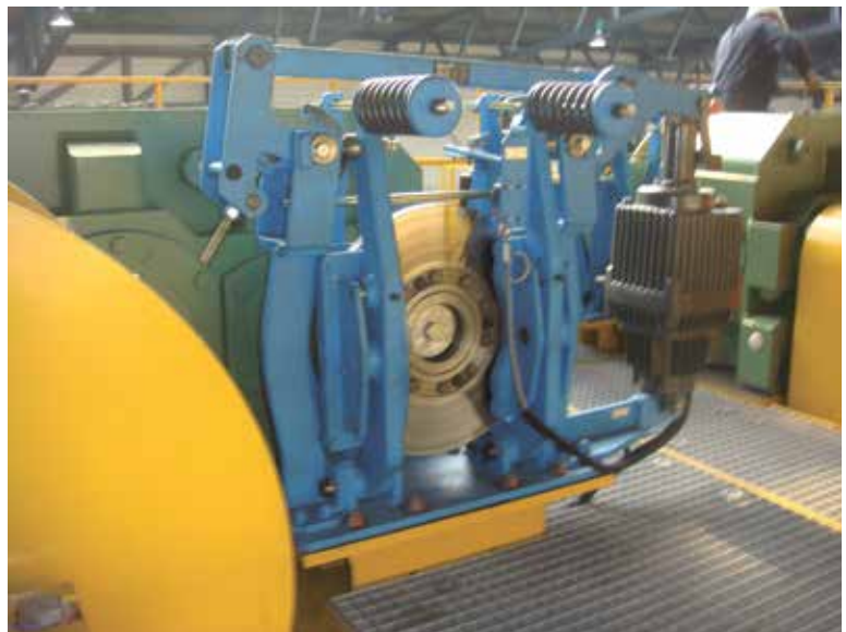
Bild 4-5 Inaugenscheinnahme einer Scheibenbremse
