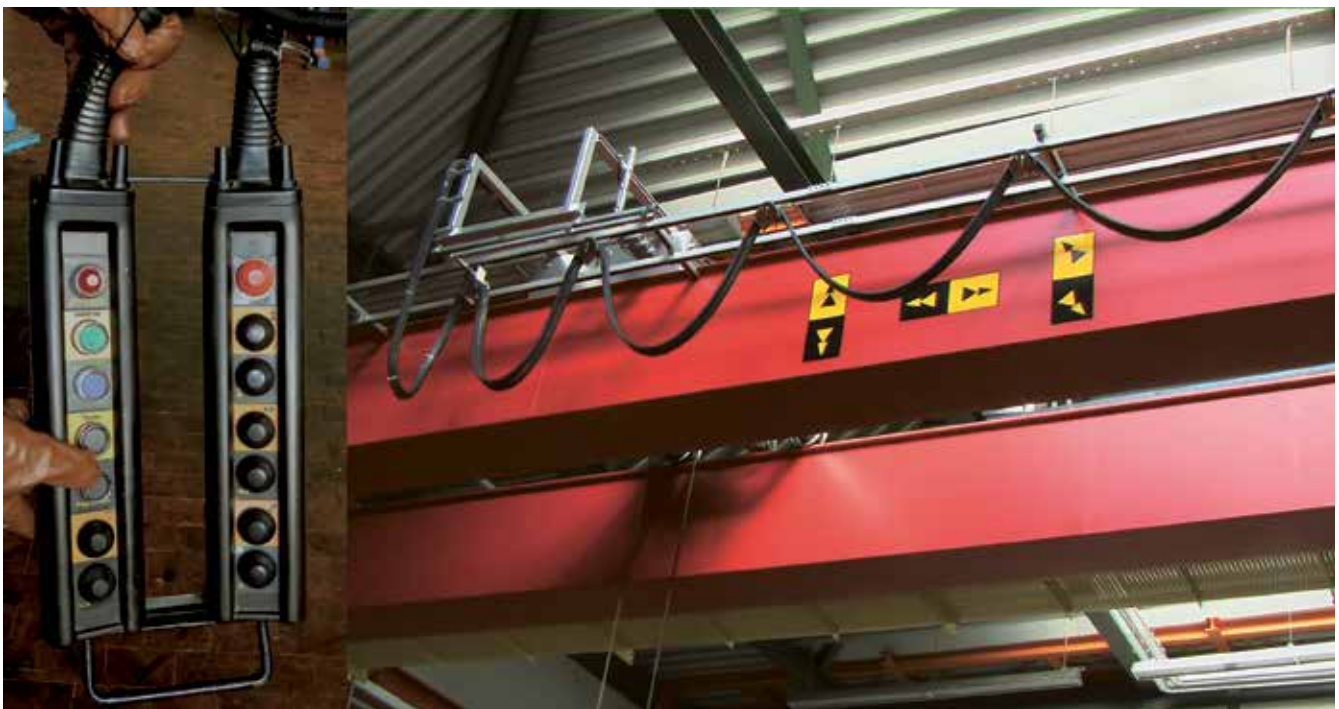
Bild 3-6: Richtungsangaben an Kranbrücke und Steuertafel durch unterschiedliche Farben und/oder Zeichen ermöglichen auch dem Ortsunkundigen eine eindeutige Richtungsbestimmung
