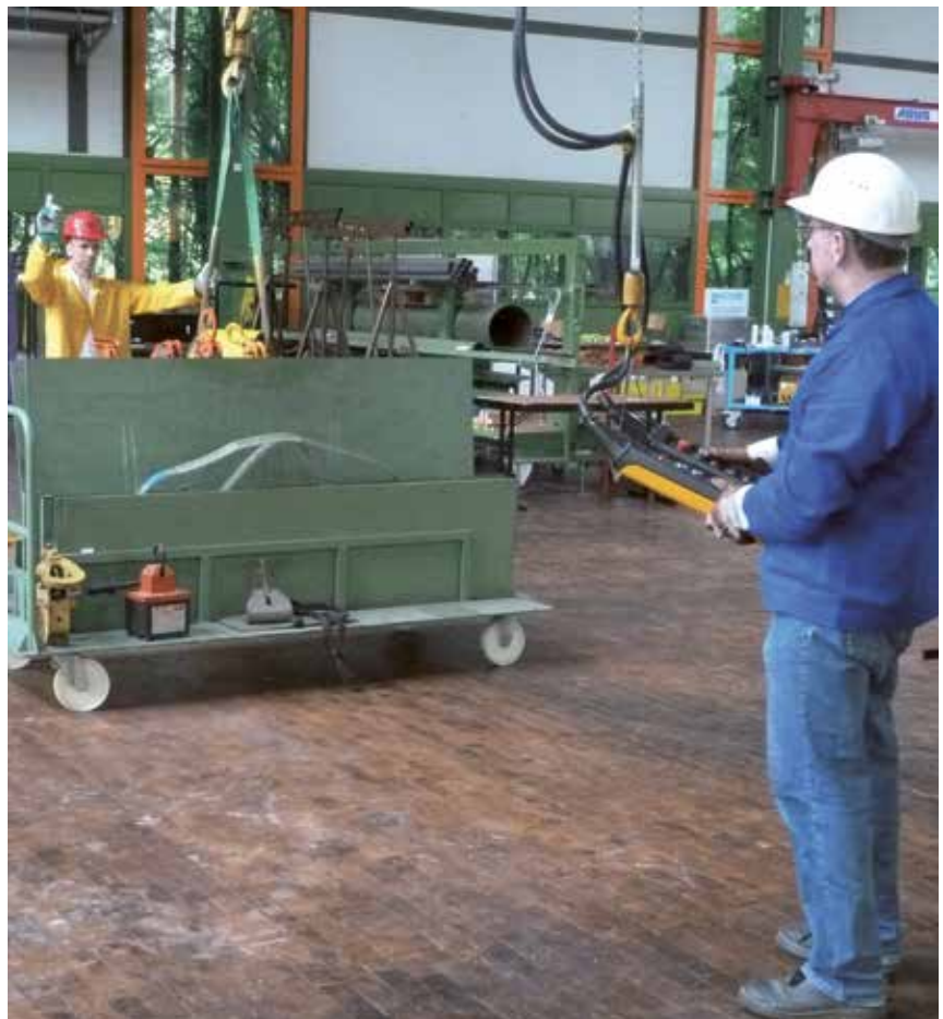
Bild 5-1: Kann der Kranführer die Last oder bei Leerfahrt die Lastaufnahmeeinrichtung nicht einsehen, darf er den Kran nur auf Zeichen eines Einweisers steuern
