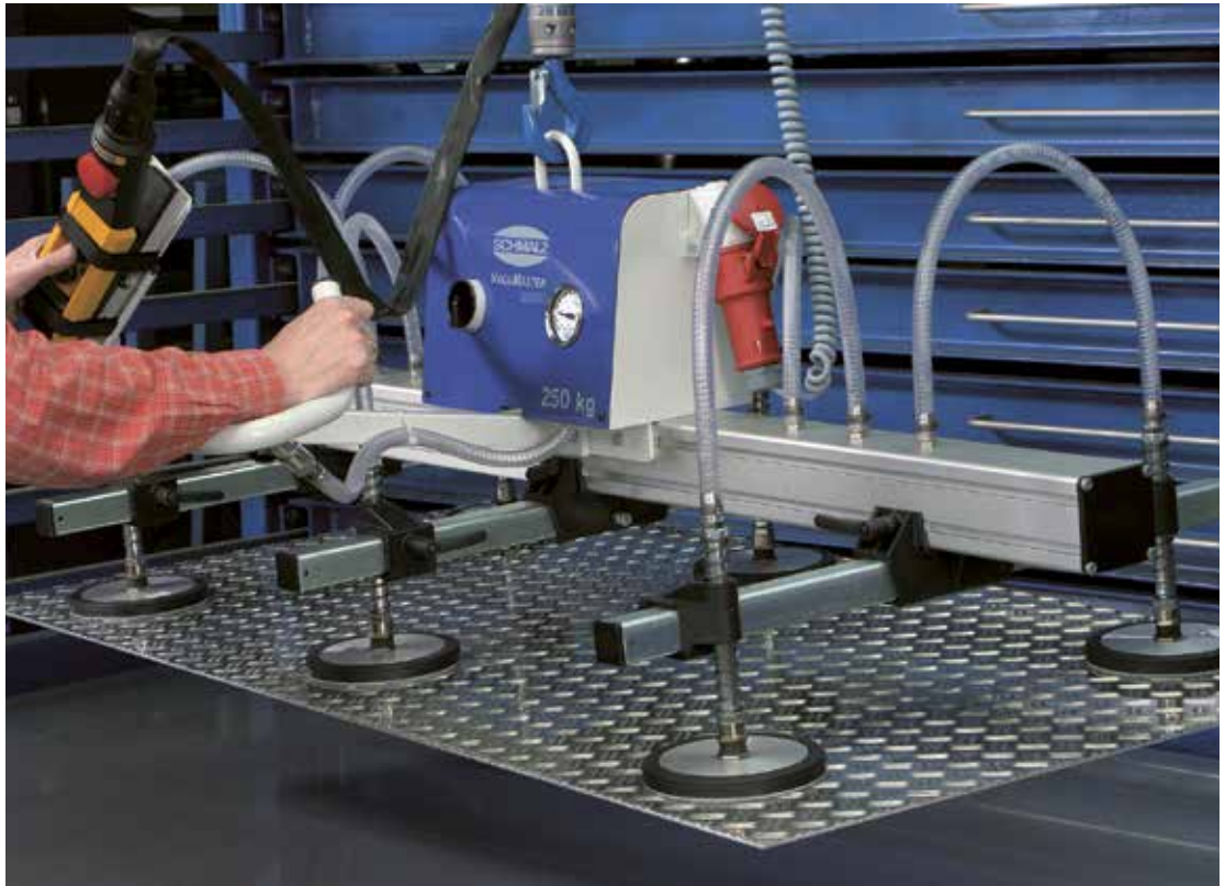
Bild 5-4: Traverse mit Saugtellern nimmt nicht magnetisierbare Blechtafel auf
