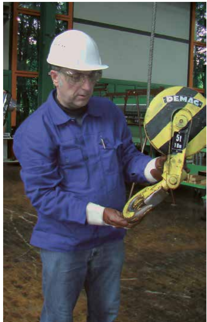
Bild 4-11: Der Kranführer kontrolliert das Hubseil und die Unterflasche einschließlich des Kranhakens auf augenfällige Mängel
