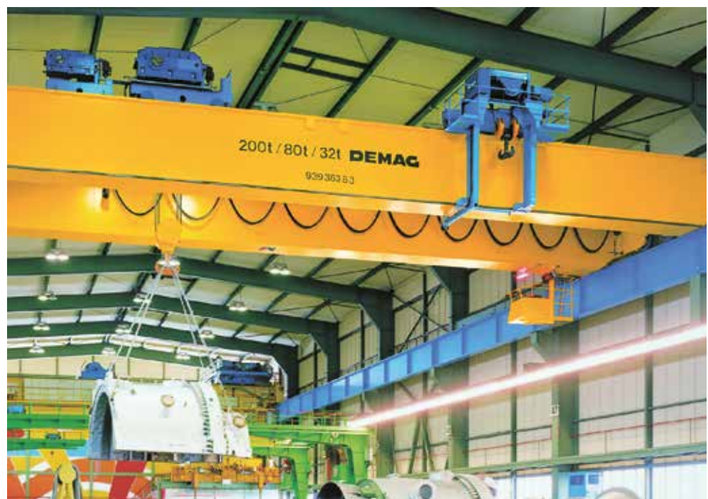
Bild 5-19: Kran mit drei Hubwerken
