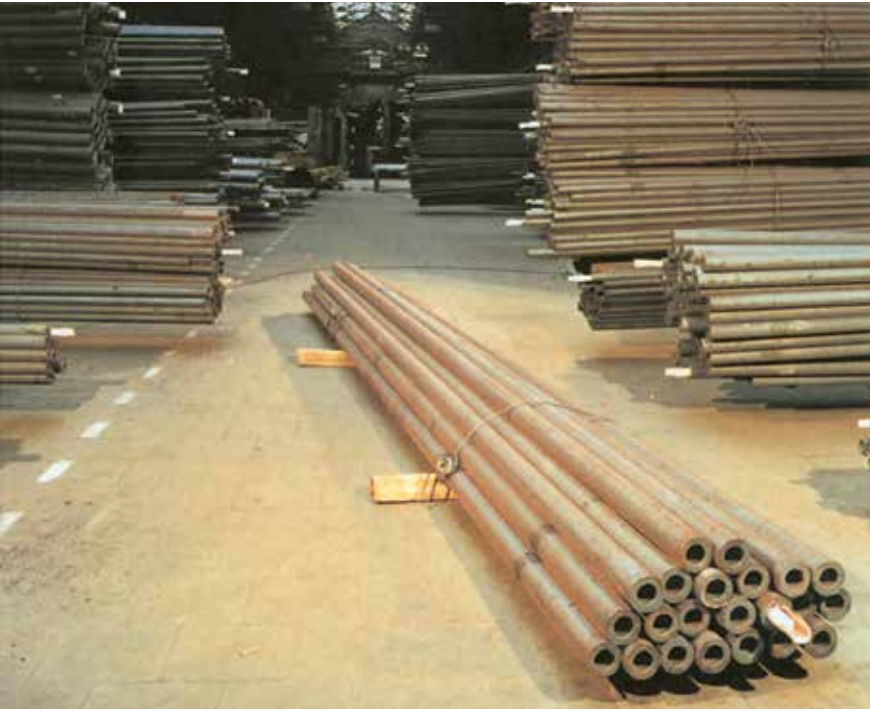
Bild 5-20: Lasten ragen in den markierten Verkehrsweg. Eine Last ist sogar hier abgesetzt
