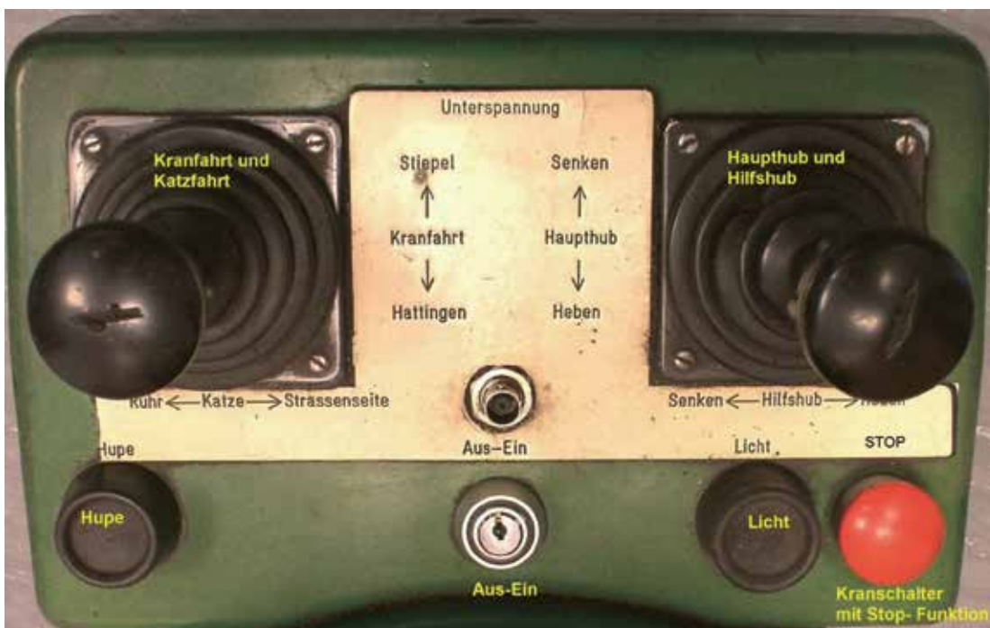
Bild 3-4: Steuergerät einer Funksteuerung mit Zuordnung der Stellteile. Zur Sicherung gegen unbeabsichtigtes Betätigen sind die Stellteile mit „Totmannschalter“ ausgerüstet; möglich sind z. B. auch Schutzbügel oder vertieft angeordnete Stellteile (siehe auch Bild 4-10)
