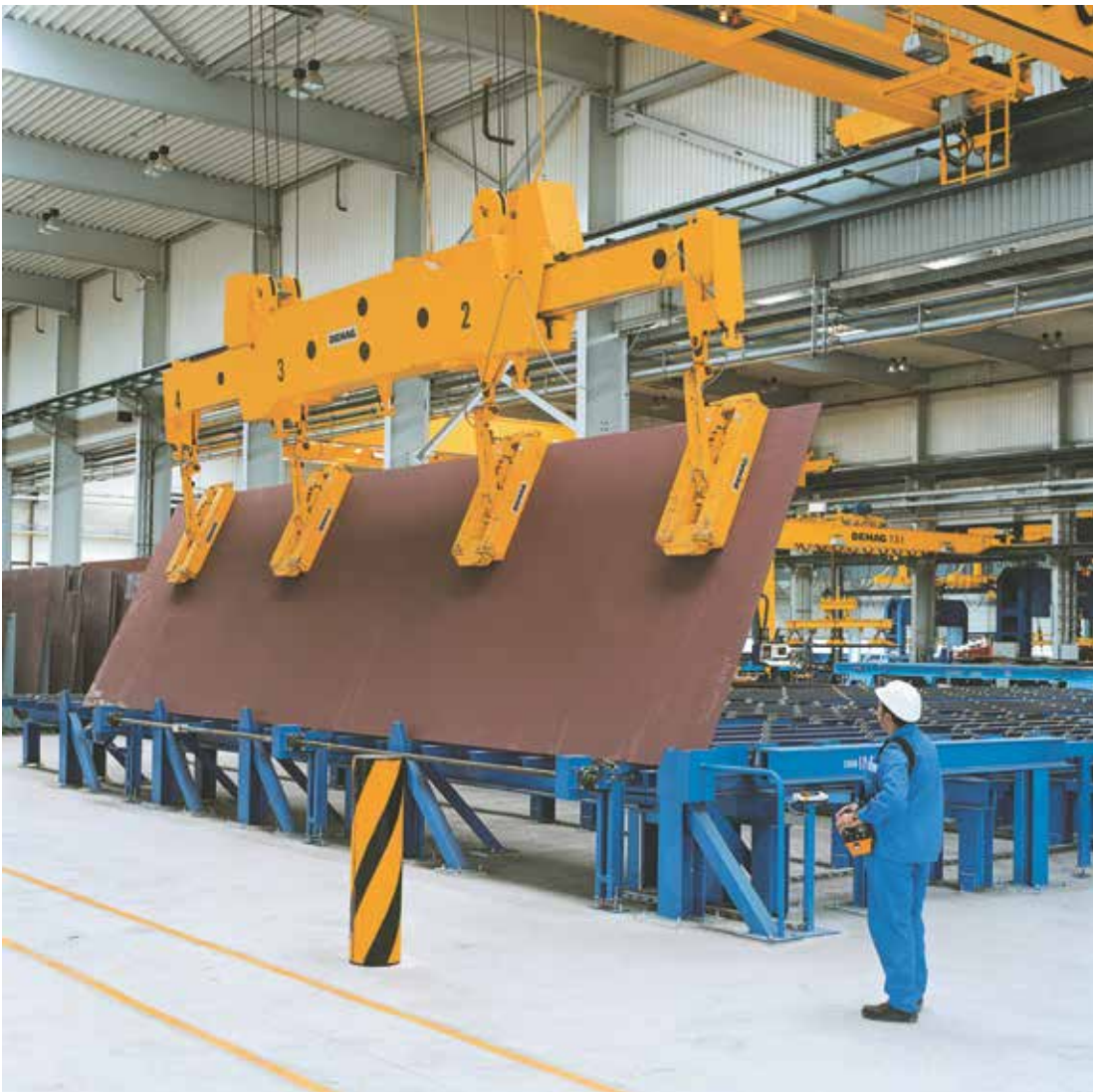
Bild 3-3: Transport einer Blechtafel mit Magneten aus sicherer Entfernung
