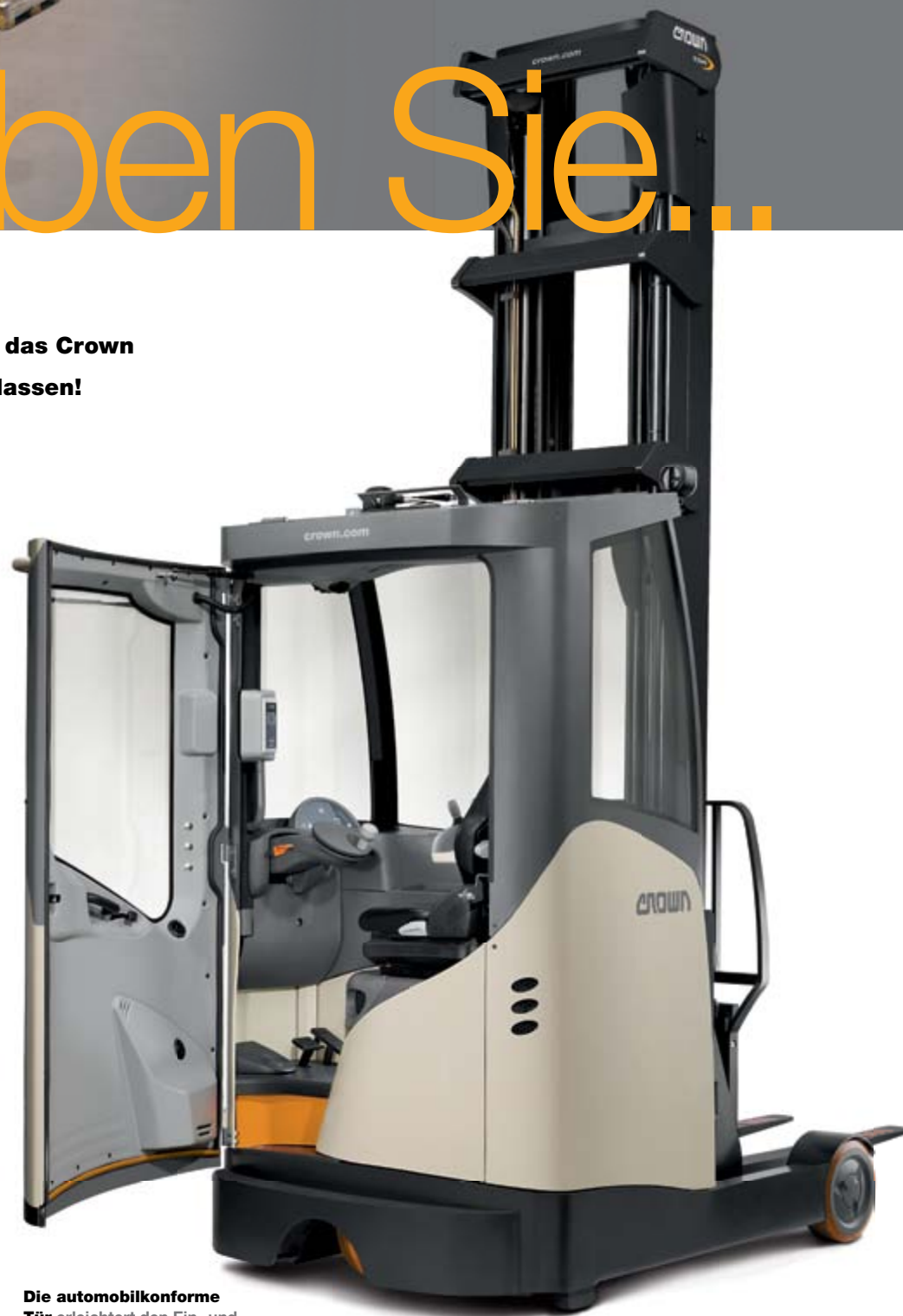
Die automobilkonforme Tür erleichtert den Ein- und Ausstieg sowie die Motorwartung.
