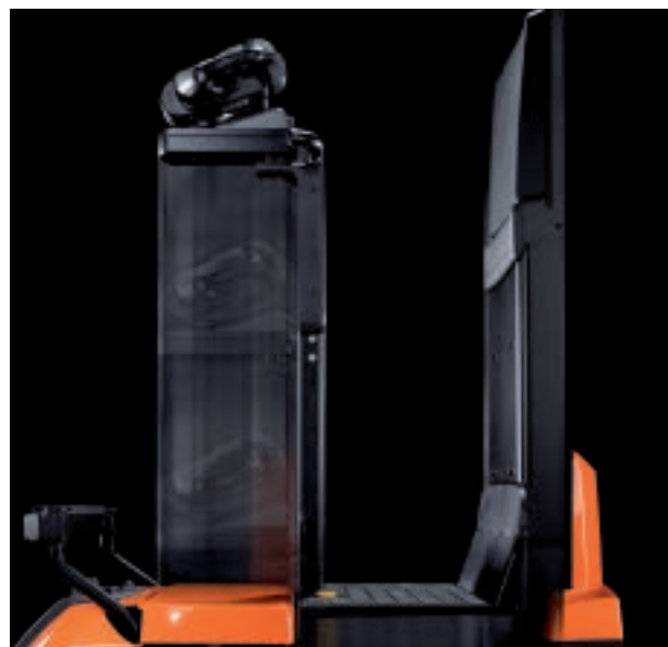
Bei Modellen mit hebbarer Fahrerplattform wird die Lenkeinheit mit angehoben – zum Fahren und Positionieren des Gerätes mit angehobener Plattform
