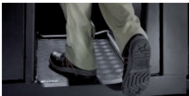
Die geringe Einstiegshöhe der BT Optio-Modelle erleichtert den Ein- und Ausstieg. Die aufgehängte Bodenplatte reduziert Vibrationen – wichtig, um gesetzliche Vorgaben für bestimmte Anwendungen einzuhalten.
