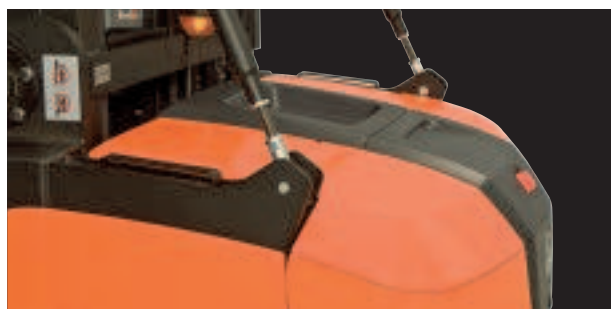
Innenliegende Bauteile wie die Batterieabdeckung sind zur Gewichtseinsparung aus Kunststoff gefertigt
