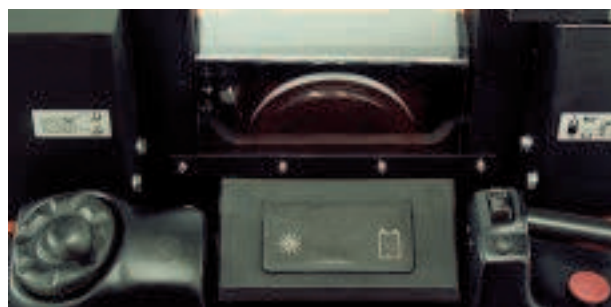
Das große Display zeigt Hubhöhe, Batterie-Ladestatus und Stellung des Antriebsrads sowie Warnungen und Fehlercodes an
