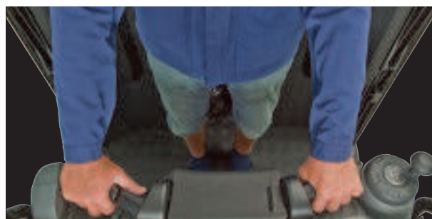
Das Mehrfach-Totmannsystem prüft, ob der Fahrer sicher in der Kabine steht, bevor das Gerät anfährt
